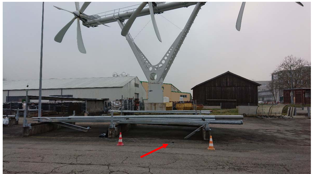
Abb. 2: Messaufstellung, roter Pfeil: Mikrofon; Foto magma AG, 22.12.2020.
